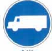
R-406 Calzada para camiones
