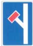
S-15c Preseñalización de calzada sin salida
